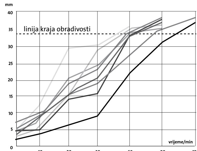
Graf prikazuje gubitak obradivosti s vremenom. Usporedna ispitivanja su rađena na cementnoj pasti od iste vrste cementa uz dodatak različitih superplastifikatora.
