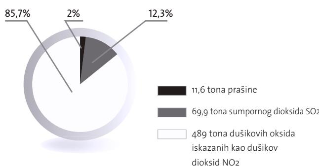
Dodatao na kontinuirano mjerjenje u proizvodnji cementa, tijekom 2006. godine izvršili smo četiri kontrolna mjerjenja, mjereći osim spomenutih vrijednosti (kako bismo ujedno i provjerili ispravnost naših uređaja za mjerjenje i dobivene rezultate) i vrijednosti teških metala, hlapivih organskih tvari, HF, HCl, amonijaka, te dva puta dioksine i furane. Sva mjerjenja su pokazala rezultate ispod graničnih vrijednosti emisija.
