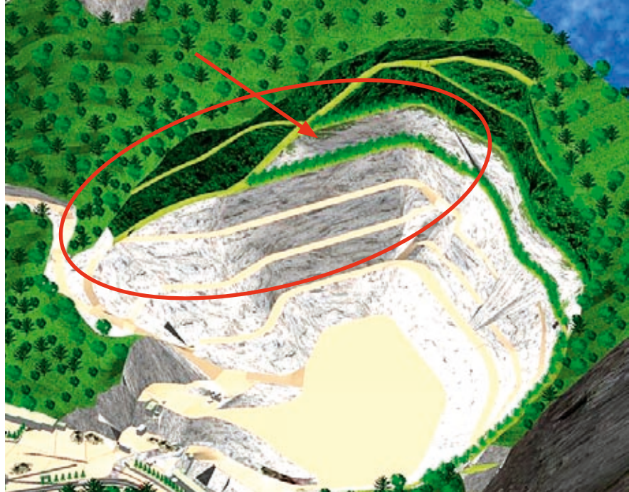
Ožujak 2008. - Kamenolomi Očura i Istočni greben spajaju se u jednu cjelinu. Uređuju se platoi, ublažavaju kosine etaža i izgrađuje glavna šumska cesta.
