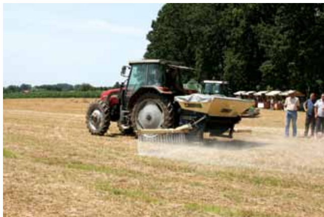
Kalcifikator za aplikaciju praškastih i granuliranih materijala
